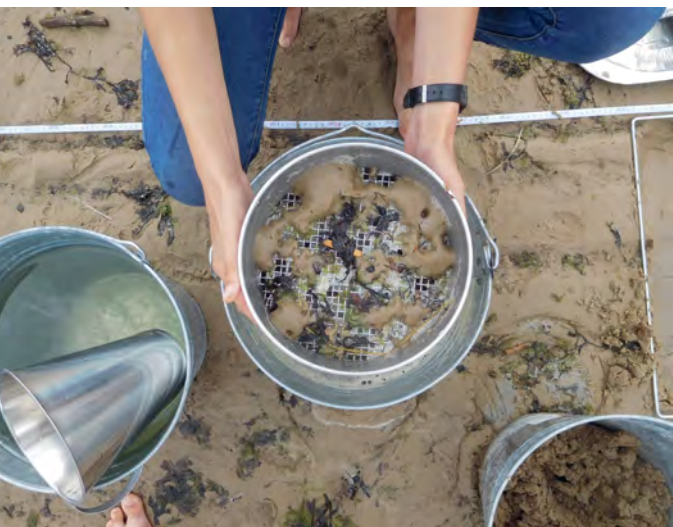
Smilšu sijāšana un skalošana tika veikta caur nerūsējošā tērauda sietiem ar acs izmēru 5 un 1 mm.
