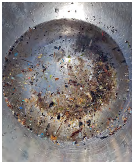
Smilšu sijāšana un skalošana tika veikta caur nerūsējošā tērauda sietiem ar acs izmēru 5 un 1 mm.
